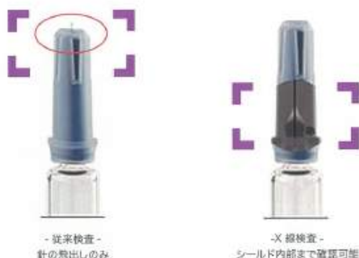
図3：X線検査システム・従来検査との違いとメリット
